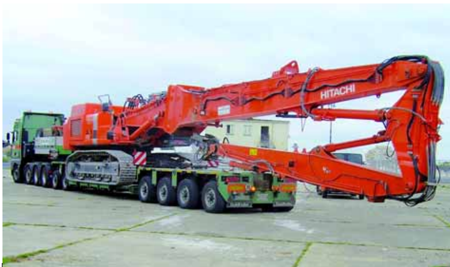
„Kleine“ Ausführung: Hier kommt der XLE in einer sechssachsigen Variante beim Transport eines ca. 48 t schweren Großbaggers zum Einsatz.
