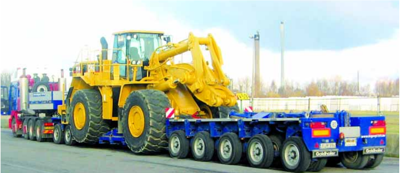
Variante mit sieben Achslinien: Der XLE 7 von Goldhofer im Einsatz beim Transport eines ca. 50 t schweren Radladers.
