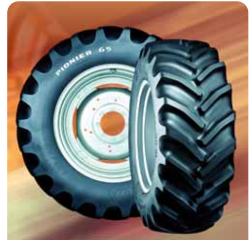
DER FULDA-ACKERSCHLEPPER-BREITREIFEN wurde für Schlepper bis 160 PS und für eine Höchstgeschwindigkeit von 50 km/h entwickelt.
