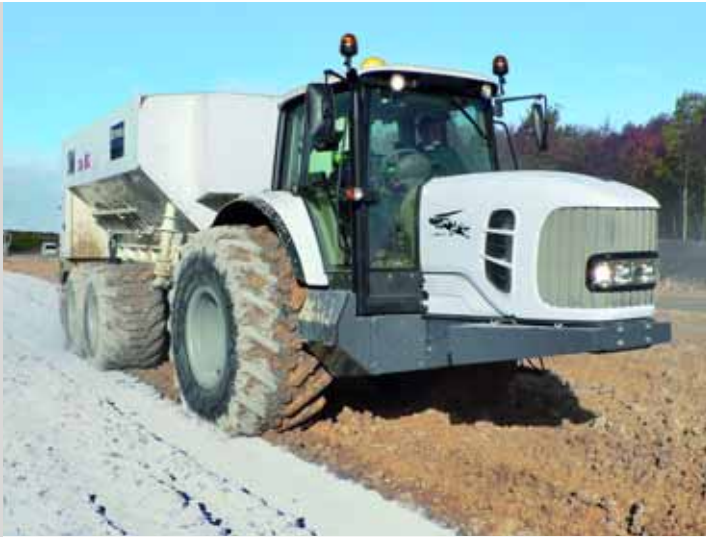
DAS KROKODIL FÄHRT VORAN: Als Ergänzung zum bestehenden Programm von Wirtgen zeigt Streamaster den Bindemittelstreuer SW 12 SC (hier der größere SW 16 SC).
