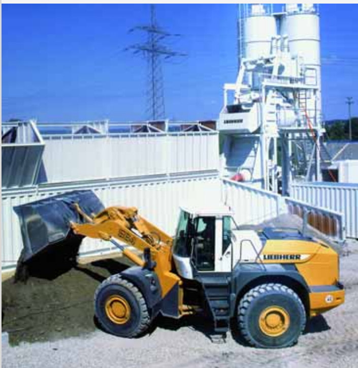
INTEGRATIONSMODELL: Die Mischanlage Mobilmix 2.25 R beinhaltet in der Grundeinheit Mischer, Beschicker, Zement- und Wasserwaage sowie Steuerraum.
