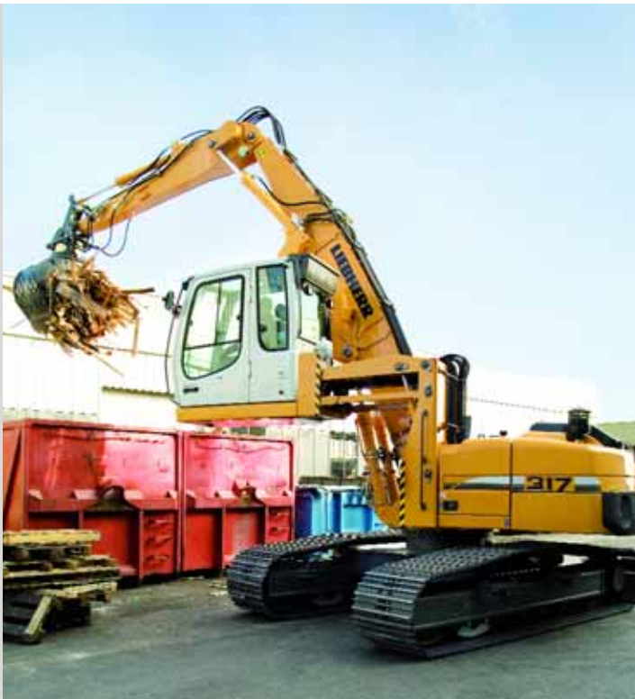
ZUSÄTZLICH: Der rund 21 t schwere Spezial-Raupenbagger R 317 Litronic erweitert die Palette der Liebherr-Materialumschlaggeräte.
