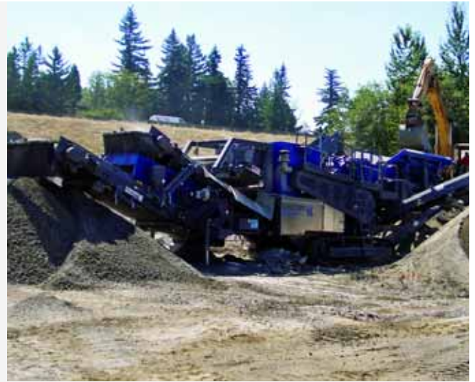
VERTRITT DAS SEGMENT MINERAL TECHNOLOGIES: Kleemann zeigt die Prallbrecher MR 130 Z und MR 100 Z.
