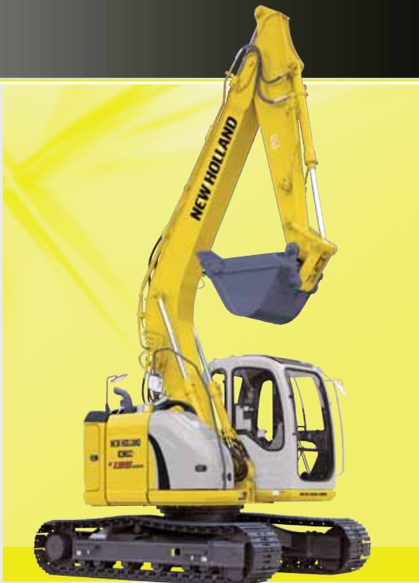
Kompaktes Heck: Der E135B SR ist insbesondere für begrenzte Platzverhältnisse konzipiert.
