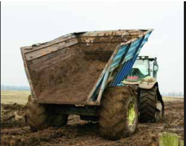
DAS DESIGN DIESES EIGENBAUKIPPER unterscheidet sich von dem moderner Hardox-Halbbrundmulden.
