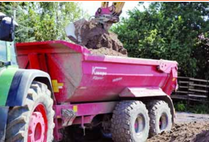
DIE BÜNDIGE RAHMENKRONE schützt vor Beschädigungen beim Beladen.
