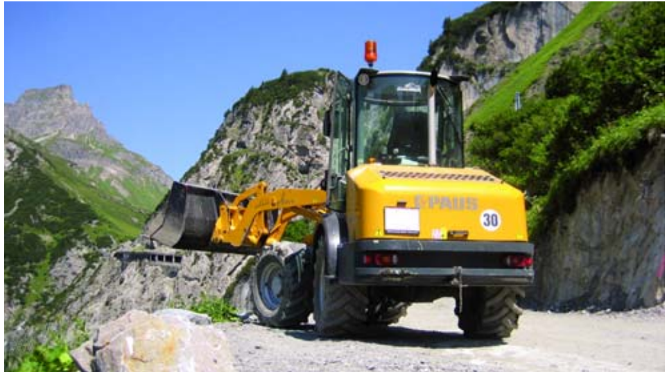
Nicht nur im Norden beliebt: Der Paus-Schwenklader SL 755 eignet sich aufgrund seiner Wendigkeit vor allem bei komplizierten Platzverhältnissen – so wie hier an der Gebirgsstraße.
