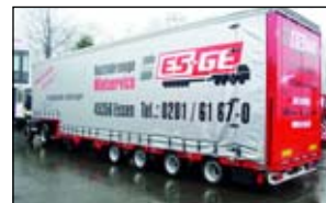
3-6-achsige Satteltiefflader in Niedrigbauweise mit Curtainsider-Aufbau, 800 mm Ladehöhe, anheb- und verbreiterbar aus ca. 4600 mm
