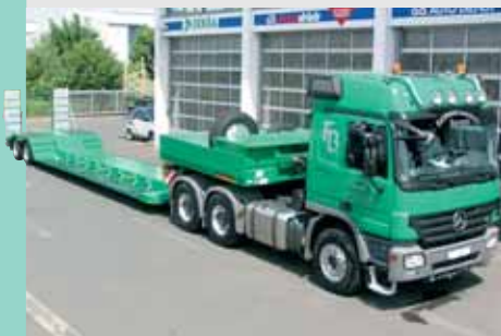
Echter Tieflader: Für den Transport von Forst- und Arbeitsmaschinen fertigt Ebert maßgeschneiderte Tiefladetrailer.
