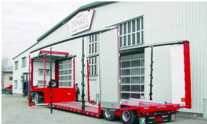
Teildemontiert für einfache Ladevorgänge: Mit einem abfahrbaren Schwanenhals können große Baumaschinen oder Maschinenteile vergleichsweise schnell be- und entladen werden.
