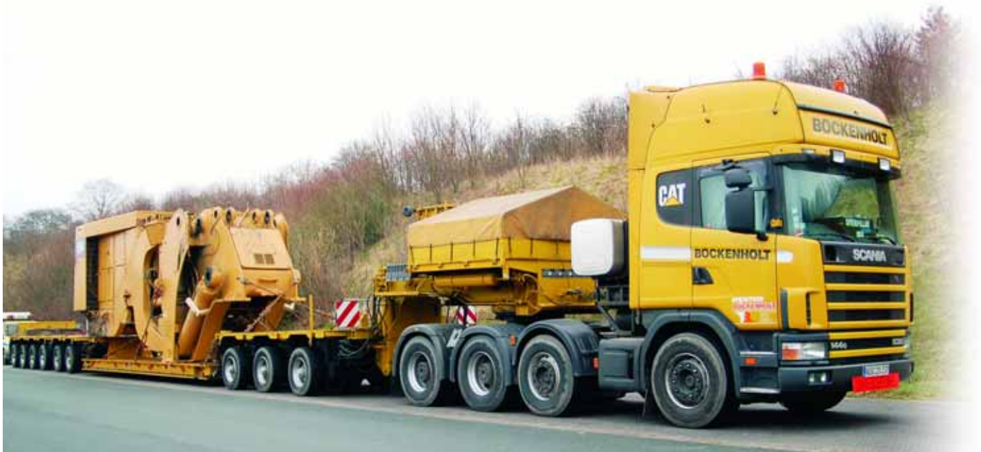
A longs Fahrwerk: Insbesondere bei überschweren Ladungen wie teildemontierten Baumaschinen sind vielachsige Fahrzeuge zur gesetzeskonformen Gewichtsverteilung notwendig.
