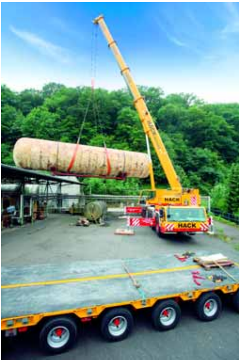
Kompaktes Gerät: Angesichts der engen Platzverhältnisse konnte der AC 160-2 mit seinen geringen Maßen punkten.
