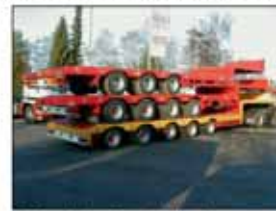
2 – 8-achsige Satteltiefelader, teleskopierbar, hydr. oder nachlauf gelenkt
