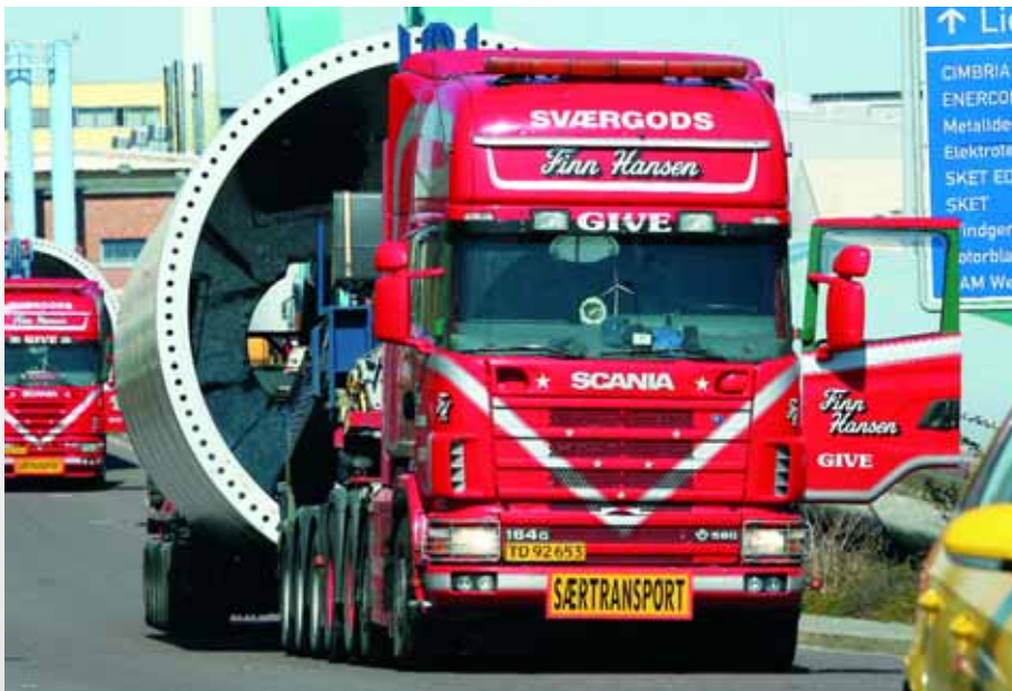
ALLES IST MÖGLICH: Die Scania-Tochter Laxå Special Vehicles rüstet die Schwerlast- und Sonderfahrzeuge nach Kundenwunsch aus. Hier ein Scania R144 GA8x4/4 530 mit fünfter Achse.
