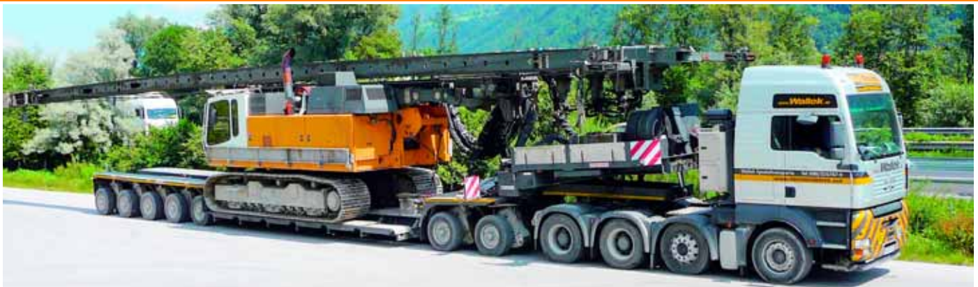
Bohrgerät auf Bergtour: 78-t-Bohrgerät auf maßgeschneidertem Chamäleon-Spezialauflieger auf dem Weg von Hamburg in das österreichische Stans.
