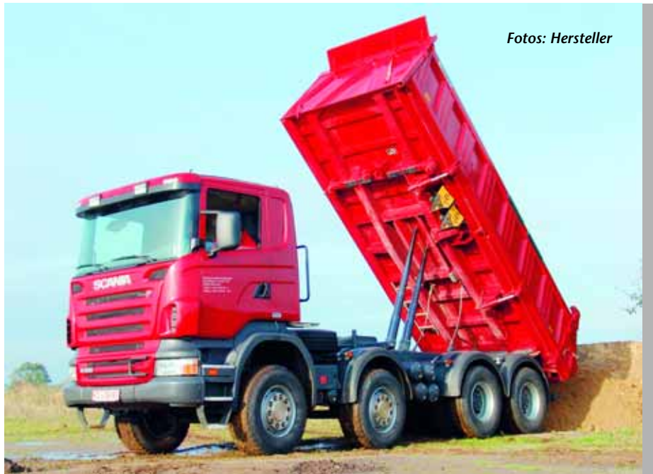
FEIN DOSIERBAR: Dieser Drei-Seiten-Kipper von Meiller ist mit Bordmatik ausgestattet.
