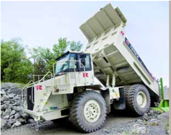
IN 13 HOCH, IN NEUN WIEDER RUNTER: Im Sinne eines rationellen Umschlag werden nur wenige Sekunden für das Entleeren der 26-m 3 -Mulde benötigt.
