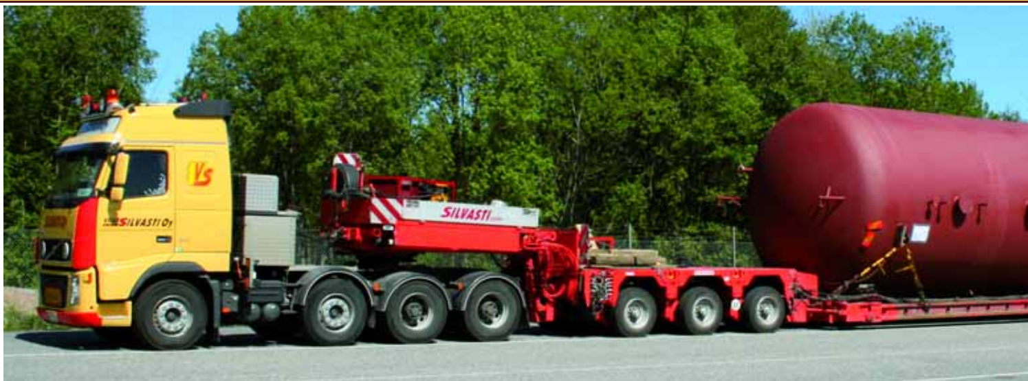
A longs Fahrwerk: Insbesondere bei überschweren Ladungen wie teildemontierten Baumaschinen sind vielachsige Fahrzeuge zur...
