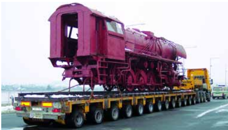
Schienenersatzverkehr: Transport einer Nostalgie-Lokomotive auf einer 13-achsigen Schwerlastkombination.
