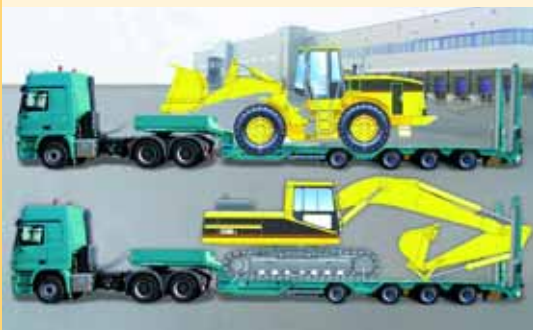
Keine Frage der Maschinenhöhe: Tief-lader für den flexiblen Baumaschinen-transport.
