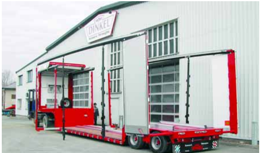
Teildemontiert für einfache Ladevorgänge: Mit einem abfahrbaren Schwanenhals können große Baumaschinen oder Maschinenteile vergleichsweise schnell be- und entladen werden.
