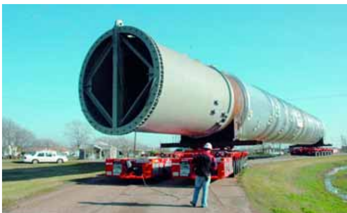
Einmal rechts abbiegen: Der 487 t und 67 m lange Kessel in einer Kurve auf der Transportstrecke.
