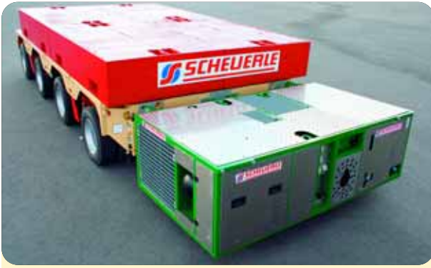
Zusätzlicher Schub: Der Scheuerle InterCombi PB als selbst fahrende Transporteinheit, der auch innerbetrieblich genutzt werden kann. (Fotos: Scheuerle)
