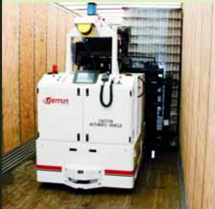
Vollständig automatisch: Ein Egemin-ATL-Fahrzeug belädt einen Lkw-Trailer.
