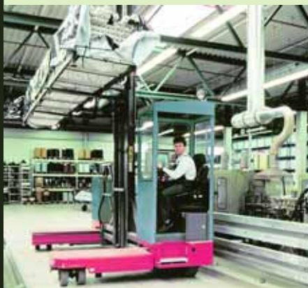
Neu zur CeMAT: Der Vier-Wege-Stapler Jumbo JEFY ist mit Tragkräften zwischen 2 und 7 t erhältlich.
