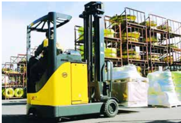
Kann drinnen wie draußen: Der OM-Schubmaststapler XRS mit Superelastikbereifung.
