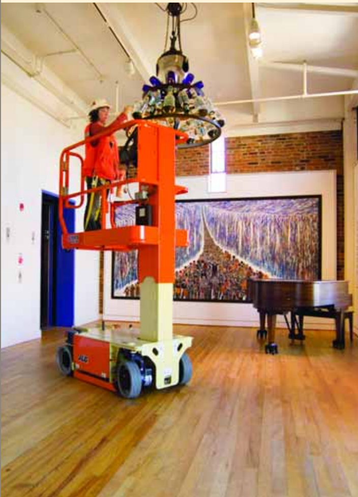
▲ ZUM LEUCHTER EMPOR: Der Senkrechtlift 1230 ES von JLG eignet sich besonders gut für Arbeiten in begrenzten Platzverhältnissen.
