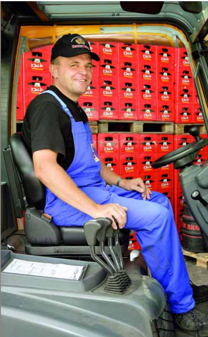
▲ KOMFORT WIE VON GEISTERHAND: Die vollautomatische Sitzeinstellung von Grammer reduziert die Belastungen für den Rücken.
