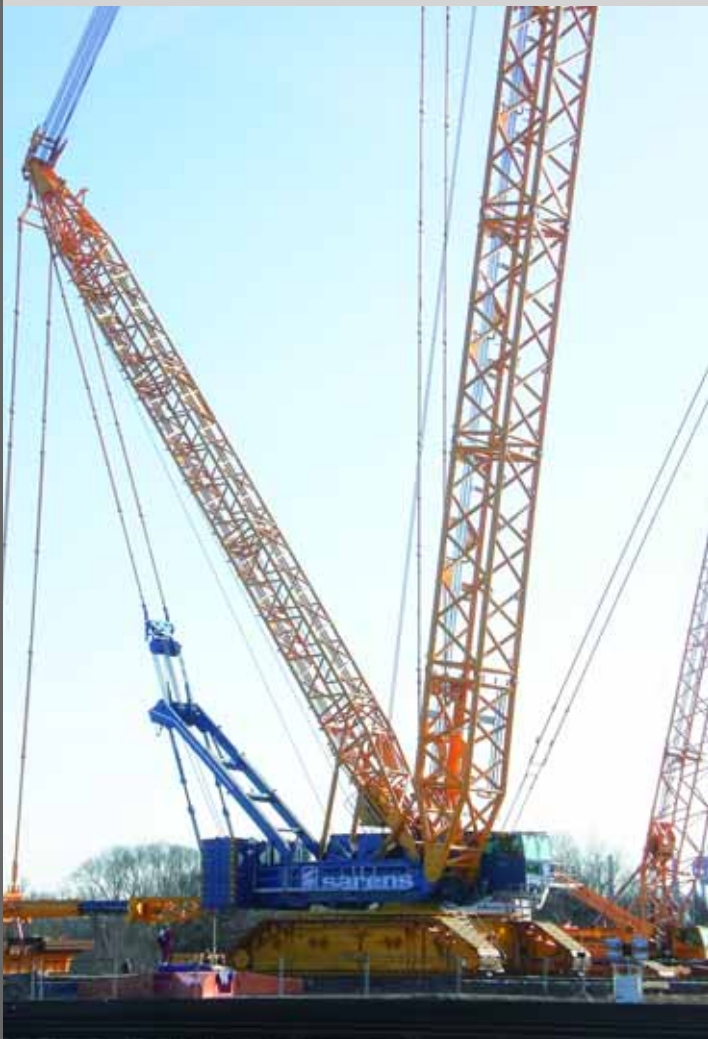
BRANCHENMODELL: Basierend auf dem CC 8800-1 entstand die WKA-Variante CC 9800.
