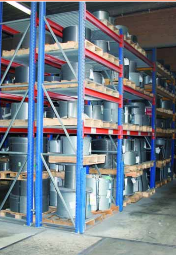
LAGERKAPAZITÄT: Rund 2000 t Material umfasst der Vorrat – darunter die 400 bis 500 kg schweren Seildrahtrollen.
