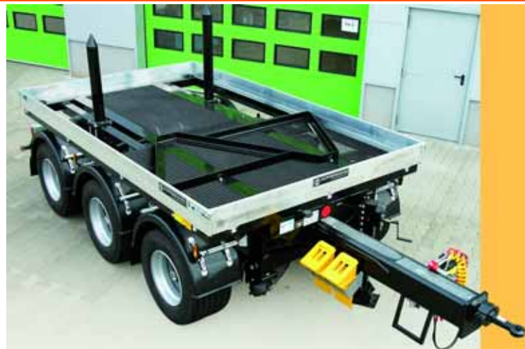
KNOW-HOW-TRANSFER: Der Ballastanhänger HTA der Hüffermann Transportsysteme ist mit bis zu drei Achsen und 25.000 kg Gesamtgewicht lieferbar.
