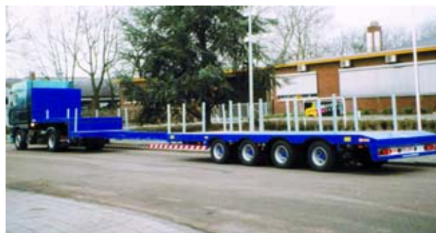
Teleskopierbare Fahrzeuge aus Venlo: Die Lintrailers-Baureihen im Tiefladebereich verfügen im Regelfall über zwei bis fünf Achsen.
