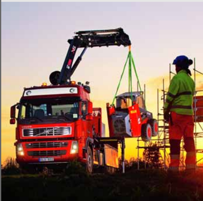
Neue Mittelklasse: Der neue Ladekran XS 211 von Hiab ist mit seinem Momentbereich von 19 bis 21 mt für eine Vielzahl von Aufgaben geeignet.
