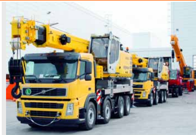
WIRTSCHAFTLICHE ALTERNATIVE: So genannte Aufbaukrane, hier bei Sennebogen, basieren auf vergleichsweise serien-nahen Lkw-Chassis.
