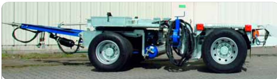
Die Modulfahrwerke GF 22-2 und GF 30-3 von Gleich Fahrzeugbau sorgen für notwendige Mobilität von Baukränen und selbsttragenden Arbeitsmaschinen. (Foto: Gleich)
