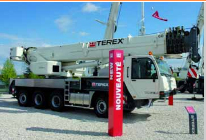
STRASSENORIENTIERT: Die kompakten Terex-TC-Modelle sind mit ihrer Lkw-Großserientechnik insbesondere auf den schnellen Ortswechsel hin konzipiert.
