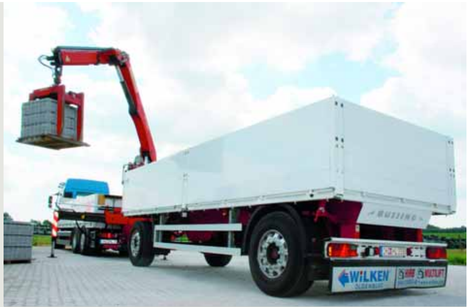
KRANEINSATZ: Da die Fahrer am Lieferort in der Regel selber abladen müssen, gehören Ladekrane zur Grundausrüstung.
